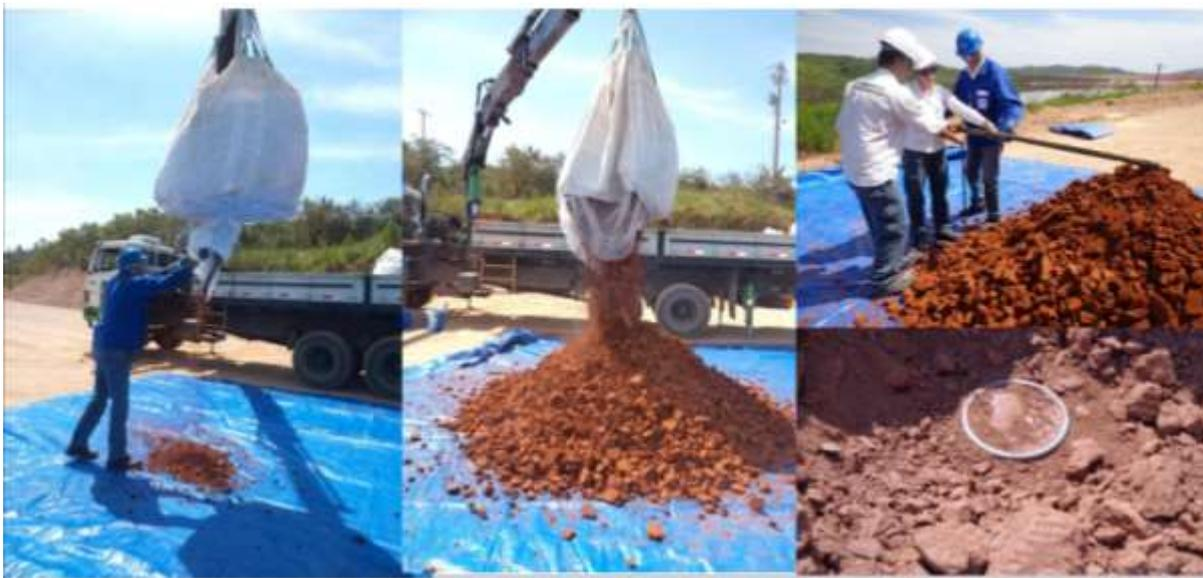
**Figura 33** - Rejeito fino após ser submetido ao processo de filtração
