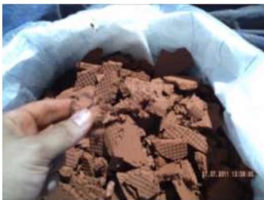
**Figura 32** - Aspecto do rejeito fino após ser submetido ao processo de filtração
