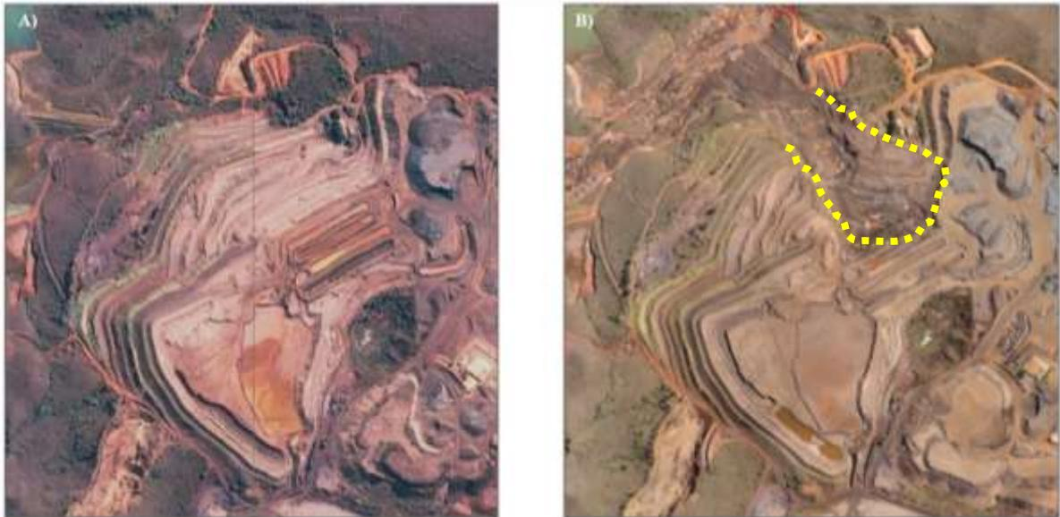
**Figuras 17 e 18** - Imagens aéreas da barragem da Herculano Mineração em Itabirito - MG antes e após o rompimento
