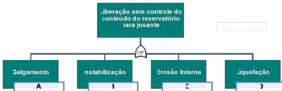
Figura 1 – Árvore de Falhas para Ruptura de Barragens (Pimenta de Ávila Consultoria, 2014, adaptado de Taguchi, G., 2014).
