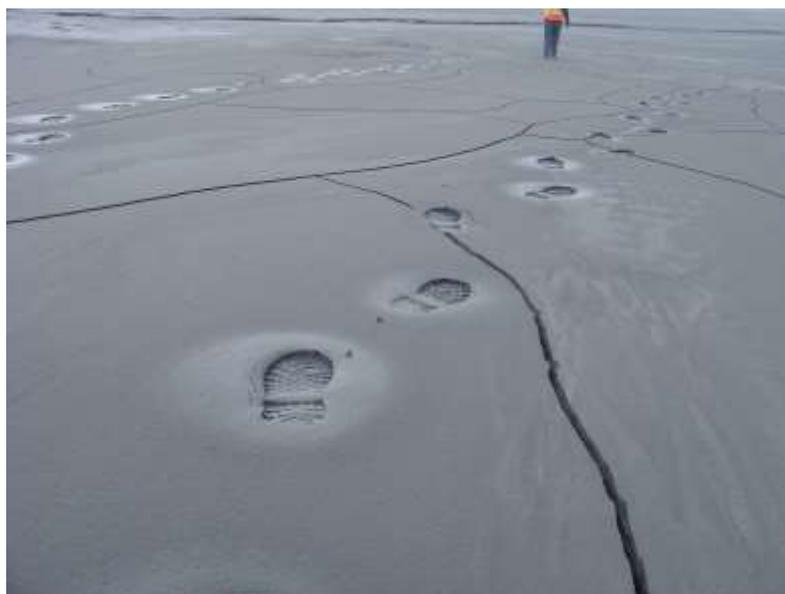
**Figura 30** - Aspecto do rejeito após a combinação de espessamento do rejeito e secagem
