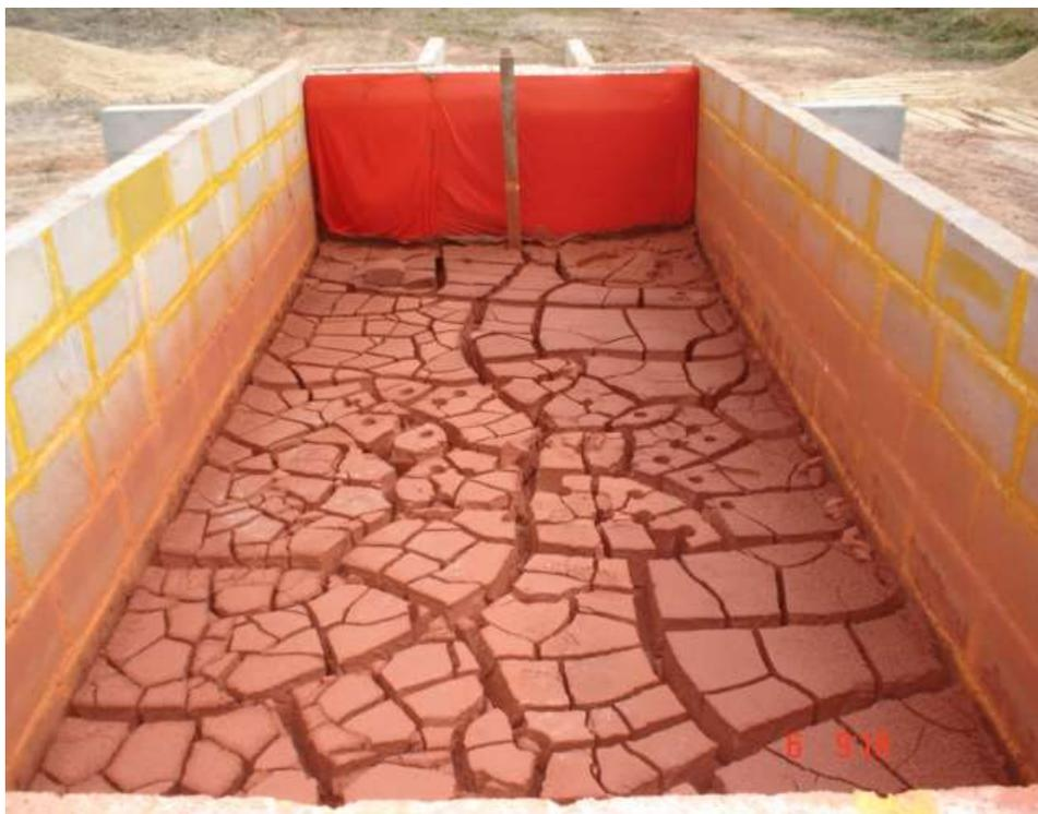
**Figura 31** - Teste de secagem de rejeitos de bauxita
