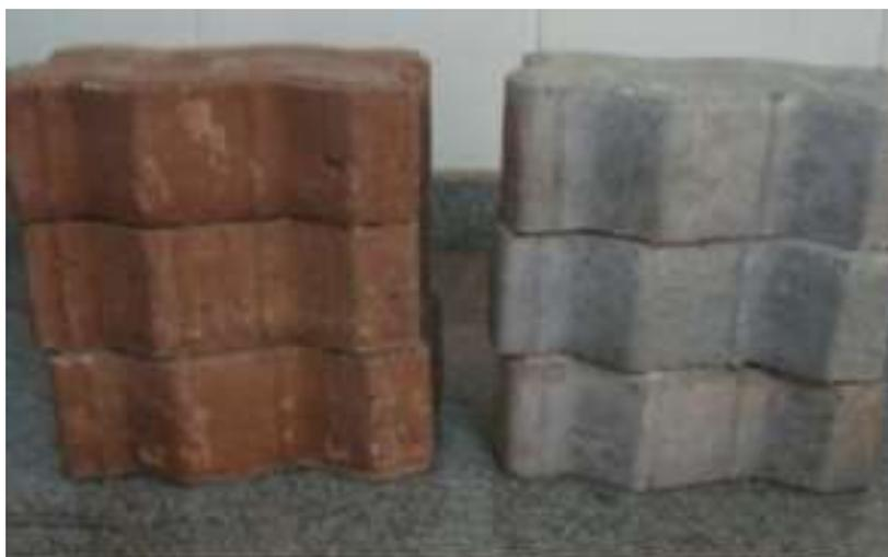
**Figura 35** - Tijolos produzidos com rejeitos de mineração
