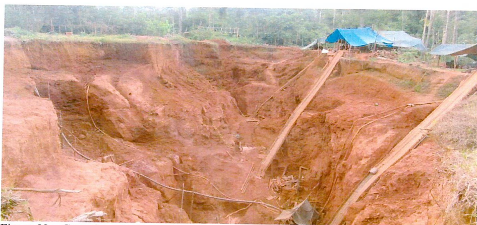
Figura 03 – Cava de extração, onde é possível ver mangueiras e rampas de transporte de polpa de sedimentos e rochas. As faces da cava estão sendo atacadas por desmonte hidráulico para formação da polpa de sedimentos, causando risco de desabamento.
