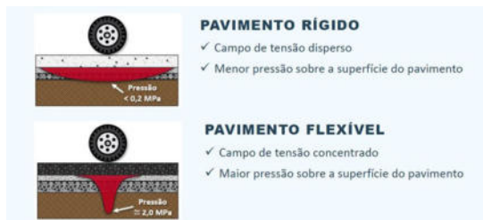
Figura 2: Ilustração sobre distribuição das tensões nos pavimentos.
